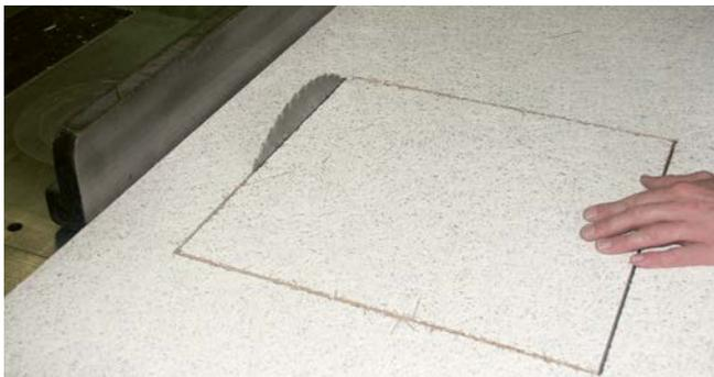
Ausschneiden der Öffnung/Deckplatte von der Plattenrückseite aus.
